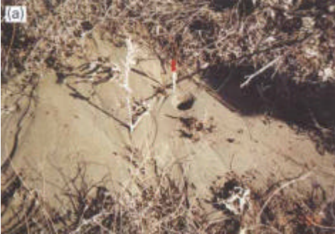
Kali çayinin güney kıyısında sivilasma olgusu (sivilasma konisi ve kum fiskirması)
